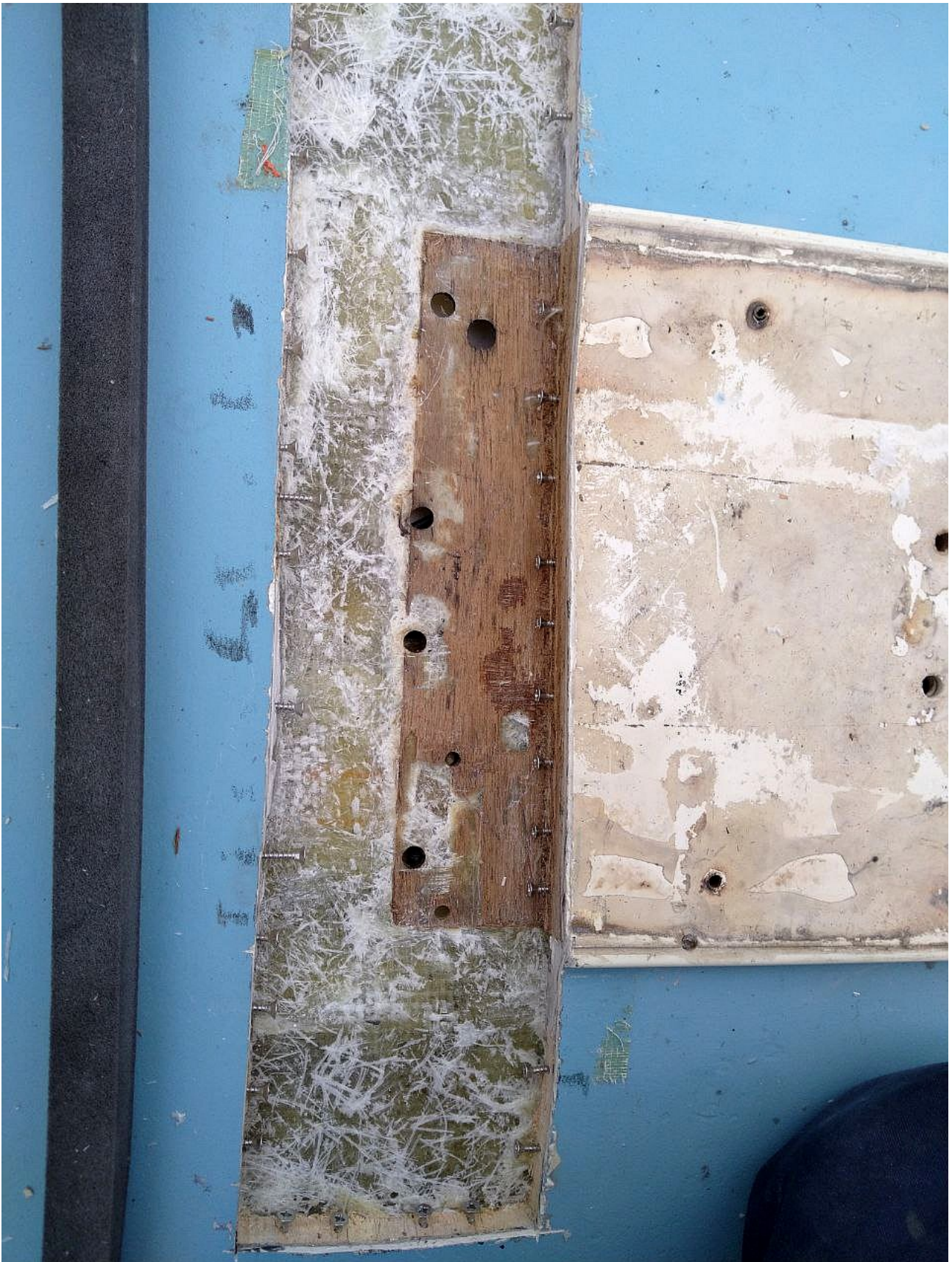
Het gebied schoon en stofvrij voorbereid. En in het hout allemaal ankerschroeven gedraaid.
