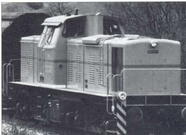
Fig. 18, 19 Grote voertuigen met dieselmotor en grote stationaire dieselmotoren hebben speciale startinstallaties nodig, die op hun speciale, door de bouwvorm bepaalde voorwaarden en toepassingsomstandigheden afgestemd zijn. Terwijl in het onderste vermogensbereik tot circa 201 motorslagruimte nog de nominale spanning van 12 ofwel 24 V gebruikelijk is, worden speciale start-
