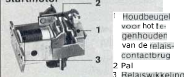
Fig. 56 Stuurrelais van een KB-startmotor
